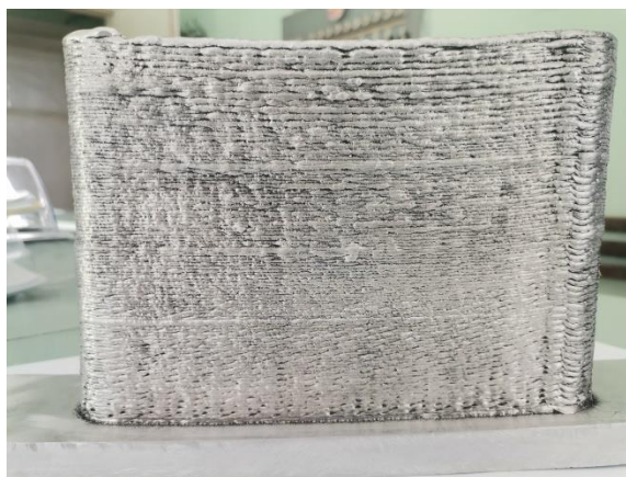
Фиг. 3. Роботизиран комплекс за електро-дъгова адитивна технология (а) и изработен по технологията детайл (б)
