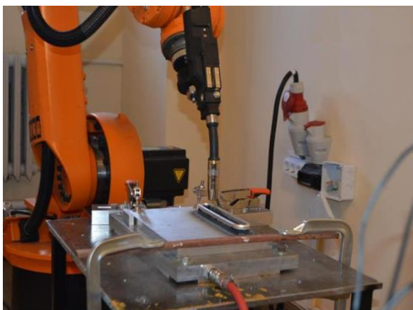
Фиг. 3. Роботизиран комплекс за електро-дъгова адитивна технология (а) и изработен по технологията детайл (б)
